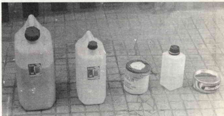
Materiale necessario al processo. Da sinistra: resina, acetone, gelcoat, catalizzatore, cera auto-distaccante.
